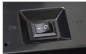
蓋の裏側にはセンサーの切り替えON/ OFFスイッチ
